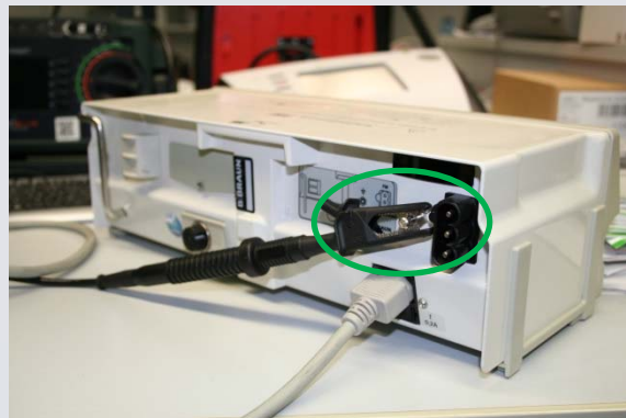
Anschluss des Prüflings an den SECLIFE ST und Anschluss der Sonde an den Prüfling
