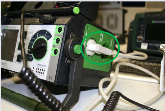
Anschluss des Prüflings an den SECLIFE ST und Anschluss der Sonde an den Prüfling
