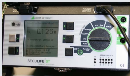
Anschluss des Prüflings an den SECLIFE ST und Anschluss der Sonde an den Prüfling
