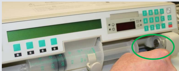
Anschluss des Prüflings an den SECULIFE ST und Kontakt an dem Prüfling (hier Infusionspumpe)
