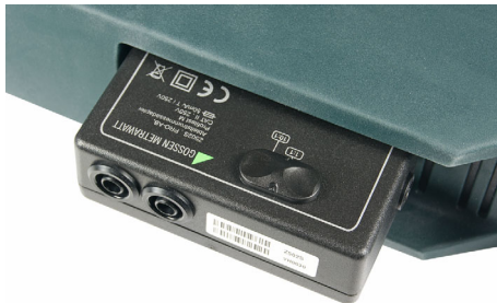
Bild 1 Ableitstrommessadapter am PROFITEST MXTRA
